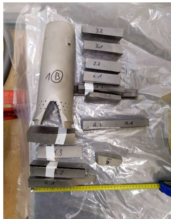
Abbildung 3: Materialproben aus dem Reaktordeckel von Block 2
