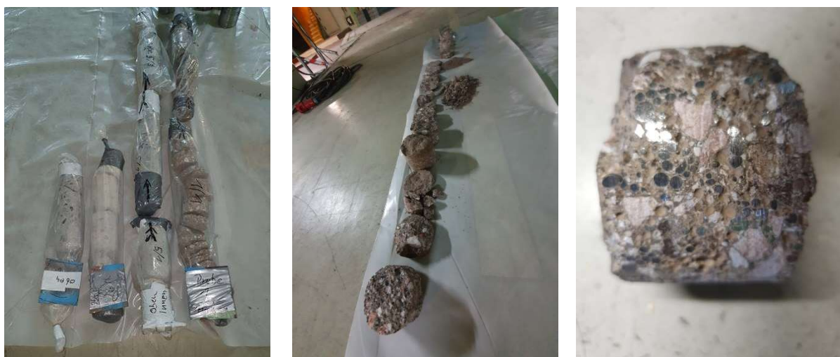
Abbildung 5: Bohrkerne aus dem biologischen Schild und dem Fundament des Blockes 2
