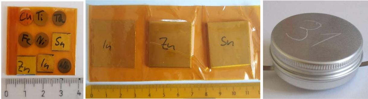
Abbildung 4: Beispiele für Monitorpakete, verpackt in Kaptonfolie, für Bereiche mit höherem (links) und sehr niedrigem (Mitte) Neutronenfluss; Aluminiumdose zum Verpacken der Monitorpakete (rechts)
